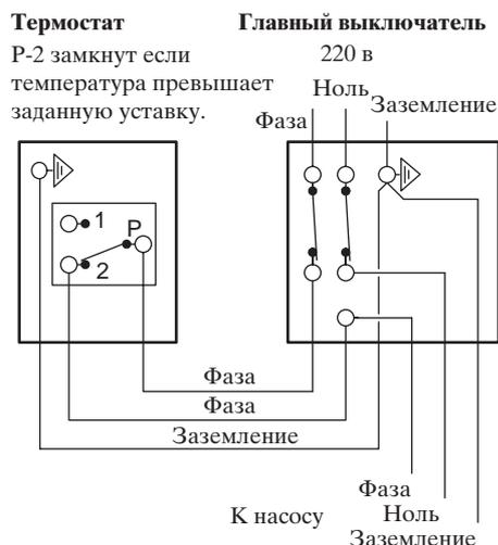
Пластиковый корпус термостата монтируют таким образом чтобы он не повредился из-за теплового излучения от горячих поверхностей. Удобным является место вблизи выключателя, чтобы уменьшить длину соединительных проводов.
