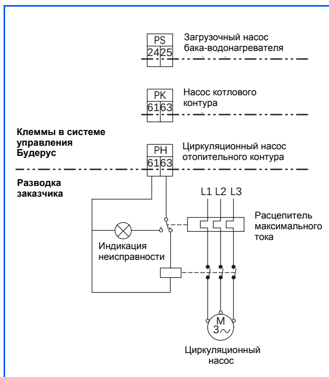
181/2 Пример подключения к системе управления Logamatic коммутационного блока заказчика для трехфазного циркуляционного насоса
