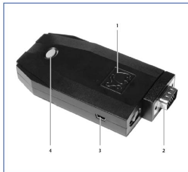
43/1 Диагностический штекер Logamatic Service Key
