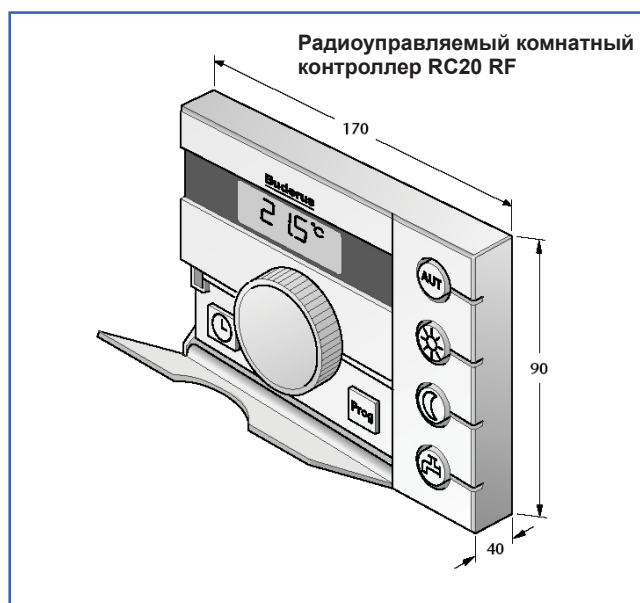
63/3 Габаритные размеры радиоуправляемого комнатного контроллера RC20 RF (размеры в мм)
