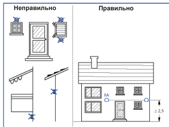
20/1 Размещение датчика наружной температуры (размеры в метрах)
