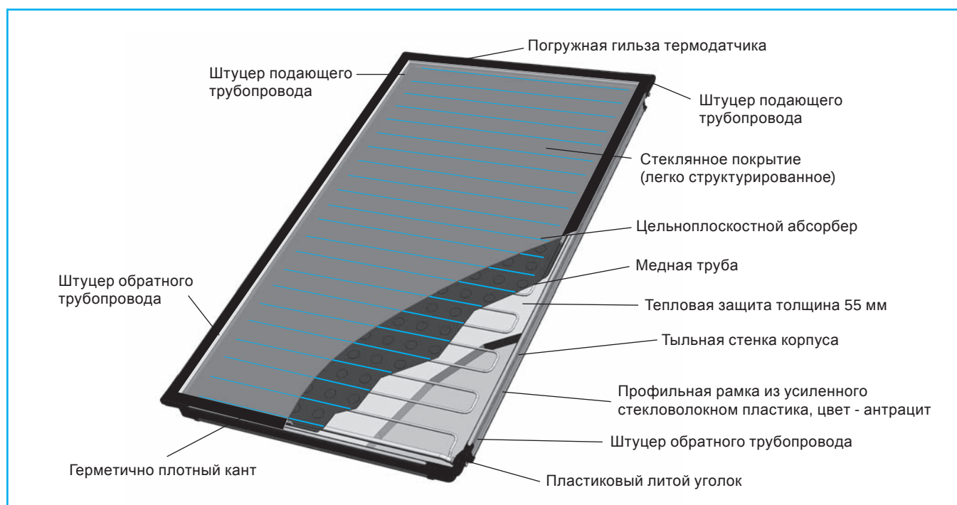
7/1 Устройство высокопродуктивного плоского гелиоколлектора Logasol SKS4.0-s (вертикального типа)
