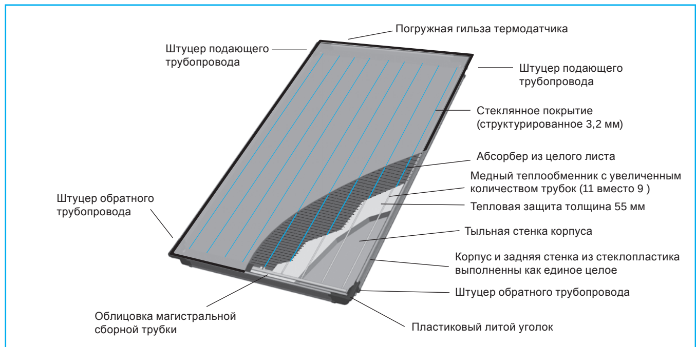
7/1 Устройство гелиоколлектора Logasol SKN 4.0
