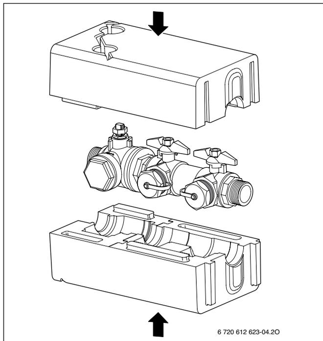
Рисунок 40. Монтаж теплоизоляции
