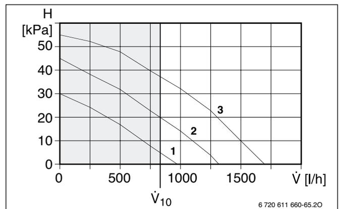
Рисунок 30. Насос отопления WPS 9
