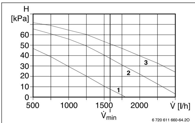
Рисунок 29. Насос холодоносителя (насос охлаждающей жидкости) для WPS 9
