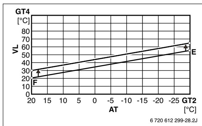
Рисунок 103. Параллельное смещение кривой отопления контура со смесителем
