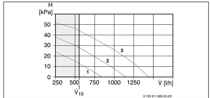
Рисунок 18. Насос отопления для WPS 6 K
