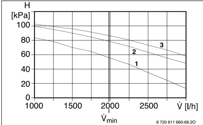
Рисунок 31. Насос холодоносителя (насос охлаждающей жидкости) для WPS 11
