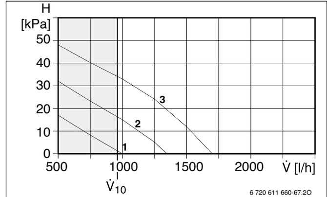
Рисунок 32. Насос отопления WPS 11
