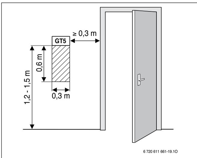
Рисунок 42. Рекомендуемое место монтажа датчика температуры помещения GT5
