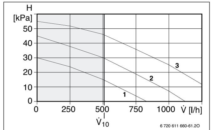
Рисунок 26. Насос отопления WPS 6
