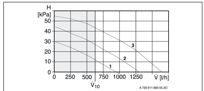
Рисунок 20. Насос отопления для WPS 7 K
