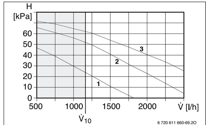
Рисунок 34. Насос отопления WPS 14
