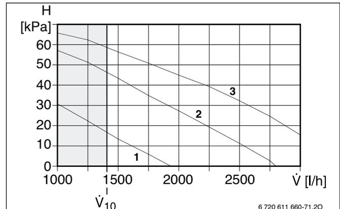
Рисунок 36. Насос отопления WPS 17
