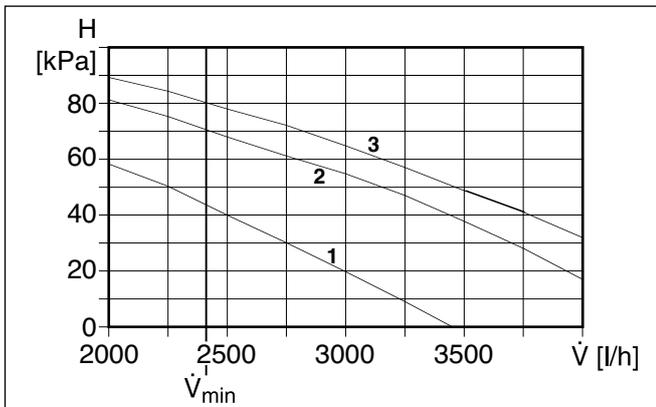
Рисунок 33. Насос холодоносителя (насос охлаждающей жидкости) для WPS 14
