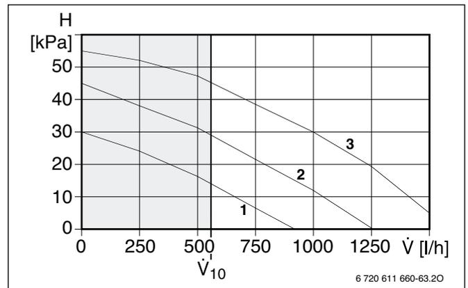
Рисунок 28. Насос отопления WPS 7
