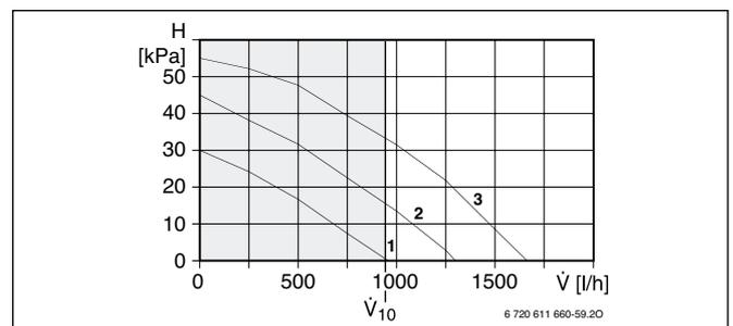
Рисунок 24. Насос отопления для WPS 11 K
