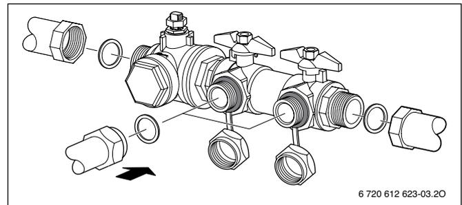
Рисунок 38. Монтаж наполняющего устройства WPS 6 ...11 K/WPS 6 ...11
