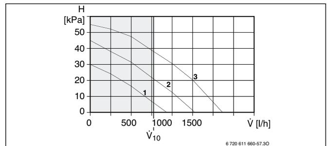
Рисунок 22. Насос отопления для WPS 9 K
