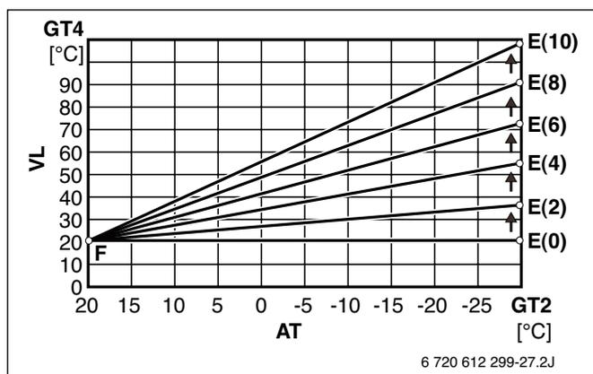
Рисунок 102. Повышение конечной точки кривой контура со смесителем
