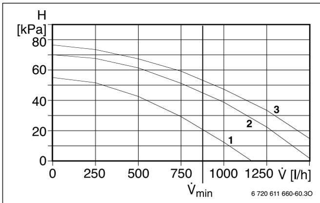
Рисунок 25. Насос холодоносителя (насос охлаждающей жидкости) для WPS 6
