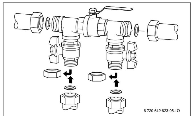
Рисунок 39. Монтаж наполняющего устройства WPS 14 ... 17
