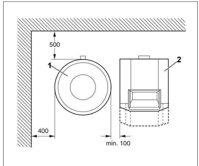
Рис. 4 Минимальные расстояния для монтажа и технического обслуживания (размеры в мм)
